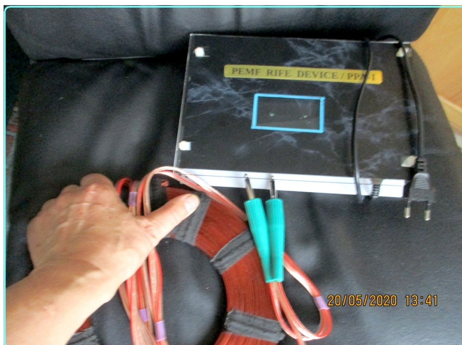
Rysunek 1: Urządzenie PPA-1: jednostka główna i cewka. Można zobaczyć wtyczki jack 6,3. Wewnątrz „ekranu” w niebieskiej ramce - dwie diody LED, odzwierciedlają one pracę obydwu kanałów transmisji.
